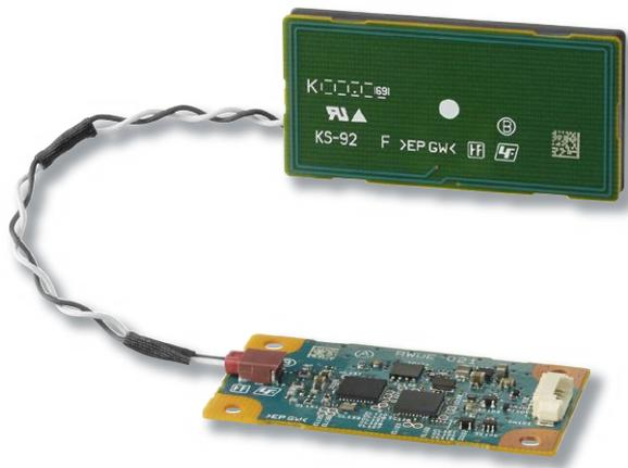
RC-S021Bは、AES暗号方式およびDES暗号方式に対応したNFCリーダーモジュールです。FeliCa™の暗号処理機能に加え、ISO/IEC 14443 Type A / Type Bの非接触ICカードに1台で対応しています。<sup>\*1</sup>
